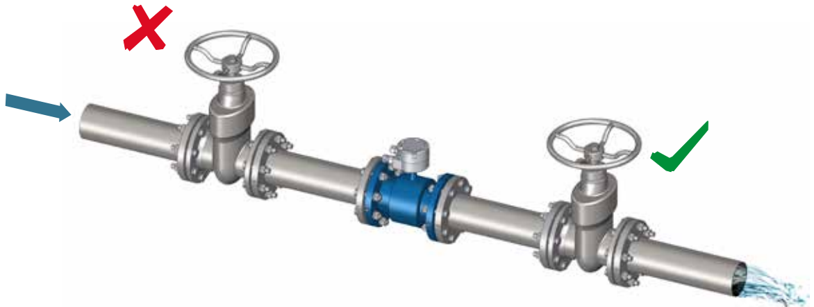
Fig. 22 Installation des robinets-vannes
