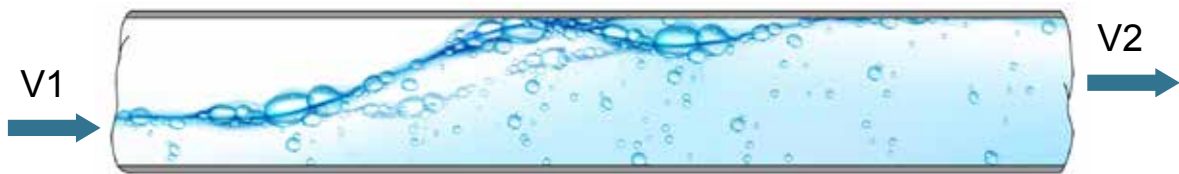
Fig. 37 Présence de l'air dans un tuyau
