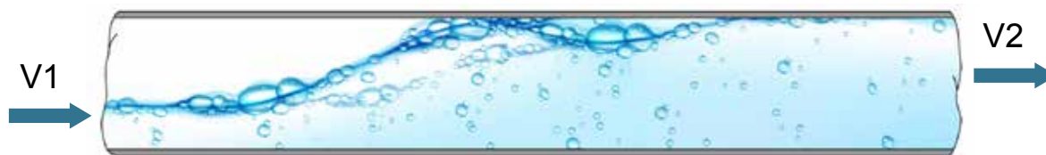
Fig. 37 Presenza di aria nella tubazione
