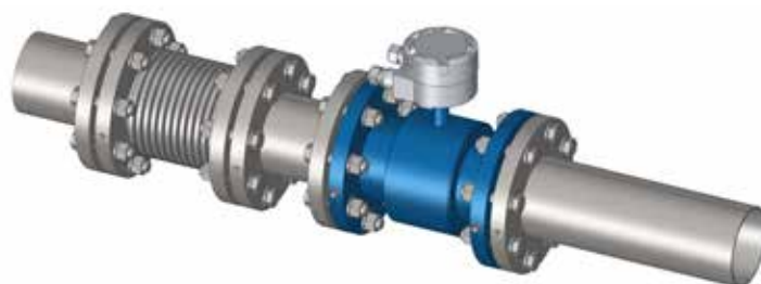
Fig. 7 Installazione con antivibrante
