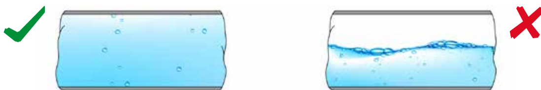
Fig. 5 Il tubo deve essere pieno di liquido
