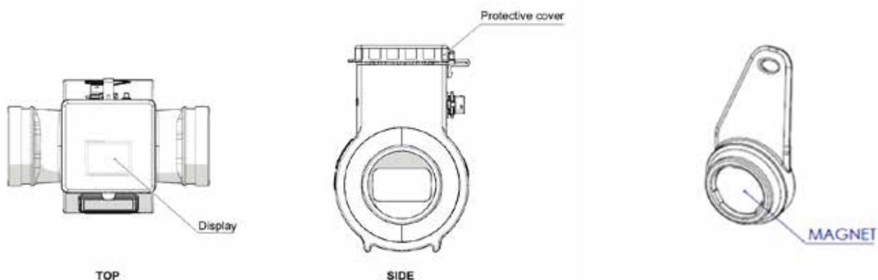
Il misuratore MUT7000 è dotato di un magnete per il funzionamento a lamella magnetica.
