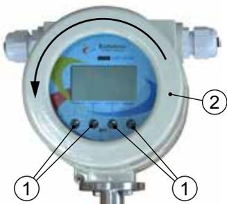
Fig. 35 Tasti di configurazione
