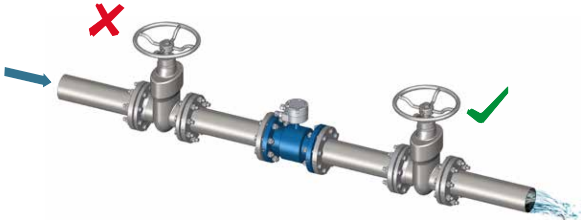
Fig. 22 Posición de válvulas de paso directo
