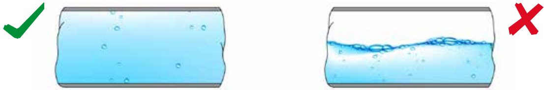
Fig. 5 El tubo tiene que estar lleno de líquido
